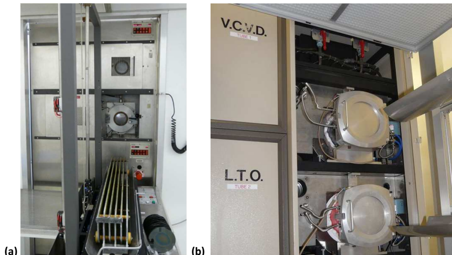
Figure 4 : Fours tubulaires pour le dépôt (a) par LPCVD et (b) par PECVD.
