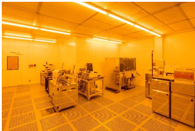
Figure 7 : Zone de 58 m 2 en classe 100 dédiée à la photolithographie et au scellement de substrats.
