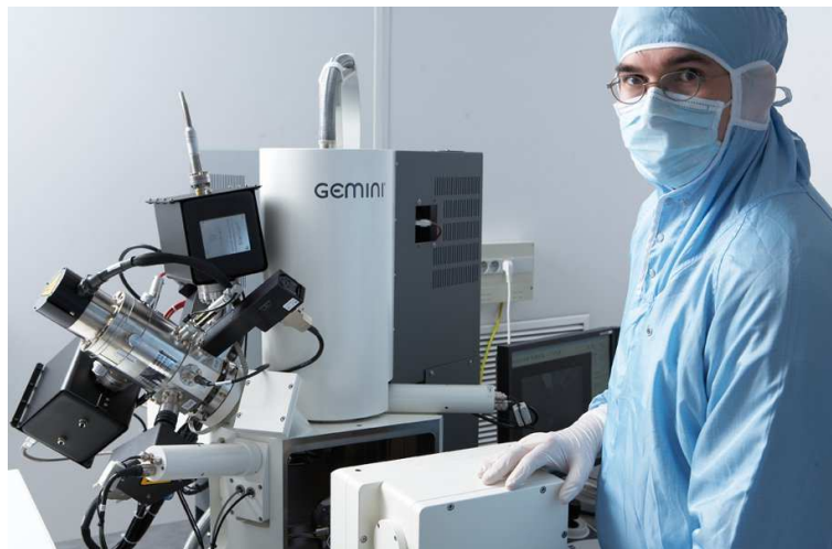
Figure 9 : Microscope électronique à balayage (MEB) à effet de champ Neon 40 (Zeiss) avec colonne FIB.
