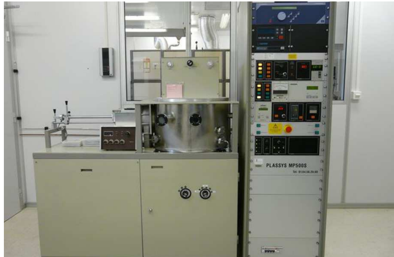
Figure 5 : Bâti de pulvérisation cathodique Plassys MP500S pour le dépôt de métaux, alliages, oxydes et nitrures.
