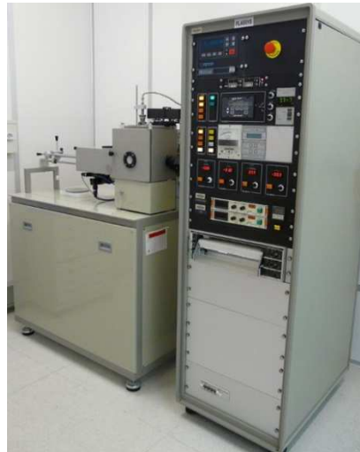
Figure 8 : Bâti RIE MG200S (Plassys) pour la gravure Cr, Al et Al 2 O 3 .
